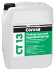
Універсальний гідрофобізатор Ceresit CT 13 призначений для надання гідрофобних властивостей сильнолужним основам (бетон, цемент, силікатна цегла, штукатурка та інші мінеральні основи). Забезпечує водозахисні властивості мінеральним основам, що вкриті мікротріщинами (до 0,2 мм).
