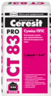
Суміш Ceresit CT 83 Pro призначена для приkleювання пінополістирольних плит при утепленні фасадів будівель і споруд. Використання суміші Ceresit CT 83 Pro (Зима)\* можливе при температурі не нижче 0 °C. Через 8 годин після застосування матеріалу допускається зниження температури до -5 °C. При утепленні фасадів мінераловатними плитами слід застосовувати суміш Ceresit CT 190 Pro.
