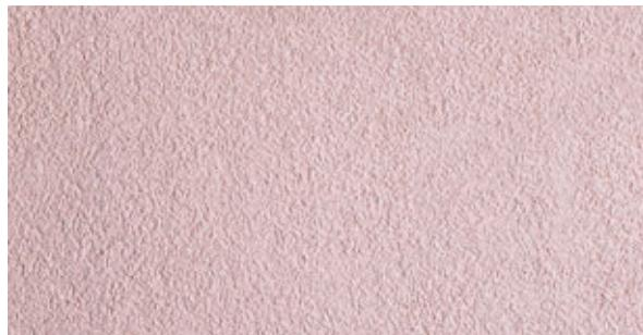
Фактура «камінцева», отримана після застосування акрилової штукатурки **Ceresit CT 60** (розмір зерна 1,5 мм), нанесеної за допомогою пластикової терки.
