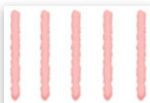
Під час кріплення плит утеплювача при теплоізоляції фундаментів — площа приkleювання до 14 м<sup>2</sup>
