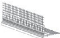
Профіль кутовий із капельником Ceresit 340 D/29.2 застосовується при улаштуванні систем теплоізоляції і виконанні оздоблювальних робіт для запобігання підтікання води (наприклад, верхні укоси віконних і дверних прорізів, виступаючі архітектурні елементи фасадів будівель тощо), замочування і руйнування верхнього шару штукатурки у зимовий період, захисту поштукатурених кутів і граней від механічних пошкоджень.
