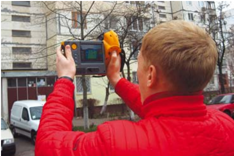
За допомогою тепловізора фахівець «ЕСКО Україна» визначає тепловтрати будинку через стіни
